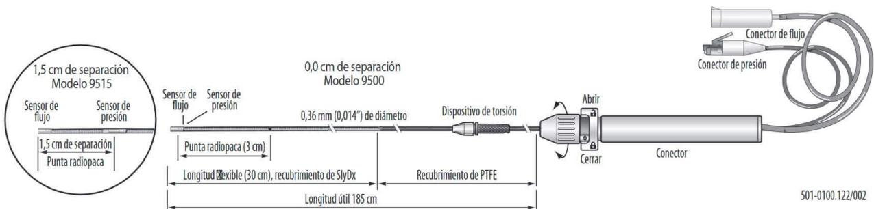
Figura 4. Guía de presión ComboWire: Características técnicas. PTFE: politetrafluoroetileno.
