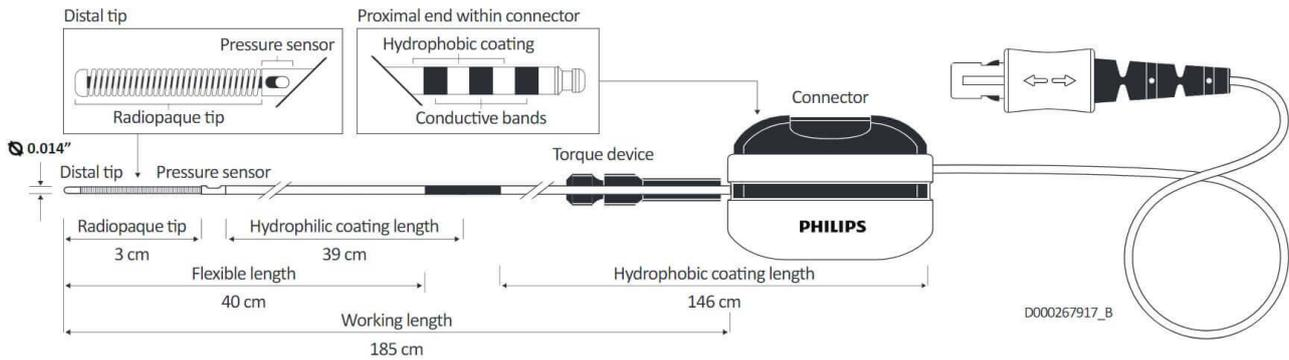
Figura 3. Guía de presión OmniWire: características técnicas.
