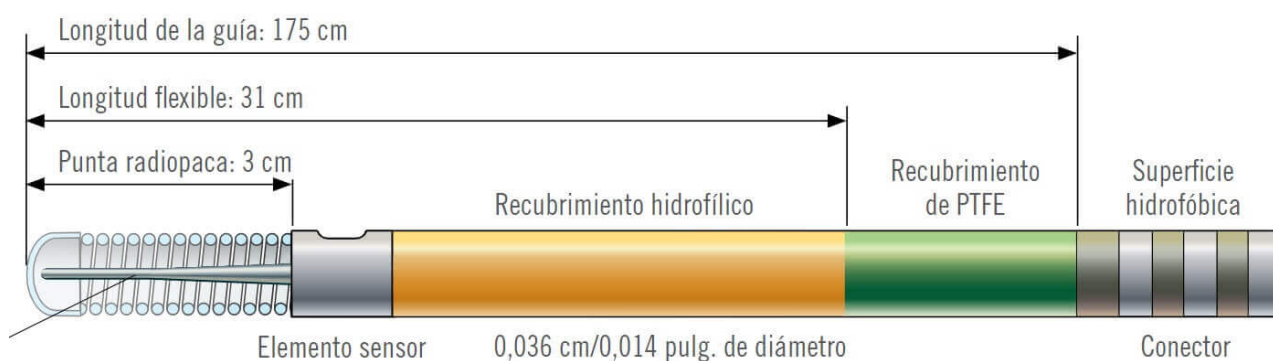
Figura 1. Guía de presión PressureWire™ X: características técnicas. PTFE: Politetrafluoroetileno.
